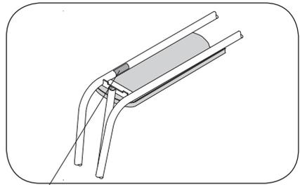
**Typenschild/Typenschild/Identification plate/Typeplaatje/Plaque signalétique/Typeskilt/Targhetta/Oznakowanie produktu/Identifikační štítek/Placa de características**
