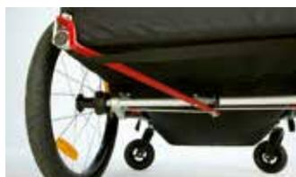
Leichter zu bedienende Feststellbremse mit Radarretierung
