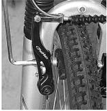
3. Legen Sie das Bremskabel sowie den Gummischutz durch das Kabelführungsrohr und fixieren Sie es am rechten Bremsarm mit der Kabelbefestigungsschraube. Stellen Sie dabei sicher, dass der Abstand zwischen den Bremschuhen und der Felge auf jeder Seite 1-1,5 mm beträgt. Ziehen Sie die Schraube mit einem Drehmoment von 6-8 Nm fest.
