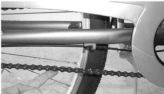
Prüfen der Kettenspannung bei Nabenschaltung mit Rücktrittsbremsnabe: Die Kette darf sich max. 1 bis 1,5 cm nach oben drücken lassen.
