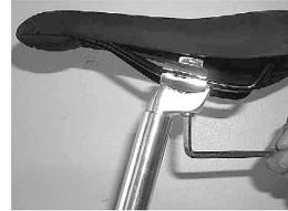
Patentsattelstütze mit Inbussbefestigung
