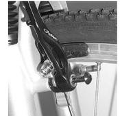
2. Wenn Sie die Bremschuhe gegen die Felge drücken, darf das Maß A nicht weniger als 39 mm betragen. Vertauschen Sie zur Einstellung wenn erforderlich die grauen Ringe (6 mm und 3 mm dick). Befestigen Sie die Bremschuhe mit den Befestigungsmuttern mit einem Drehmoment von 6-8 Nm. Die Stahlscheiben müssen dabei an dem Bremsarm anliegen.
