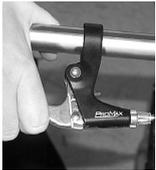
5. Betätigen Sie den Handbremshebel am Griff mindestens 8-mal, um die Funktion zu überprüfen und prüfen Sie anschließend nochmals den Abstand der Bremschuhe. Stellen Sie den Abstand gegebenenfalls, wie bereits beschrieben, nach, bevor Sie das Bremssystem benutzen.
