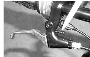
Mit Hilfe dieser Madenschraube kann an diesem Bremshebelmodell die Griffweite zwischen Hebel und Lenker eingestellt werden. Der Bremshebel darf den Lenkergriff nicht berühren.
