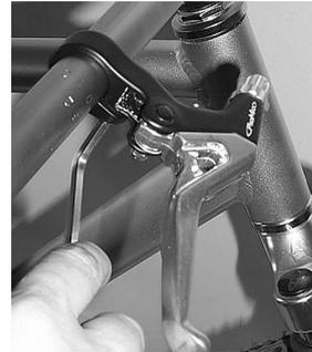
1. Montieren Sie die Hebel mit einem 5 mm-Innensechskantschlüssel an die linke und rechte Seite des Lenkers. Ziehen Sie die Schrauben mit einem Drehmoment von 6-8 Nm fest.
