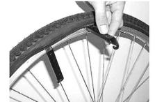
**Hebeln Sie die Reifen nicht mit Schraubenziehern und anderen scharfkantigen Werkzeugen ab. Sie können den Reifen dadurch beschädigen!**
