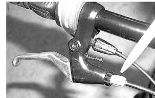
An dieser Schraube kann bei diesem Bremshebelmodell die Längung der Bremsseile ausgeglichen werden. Wenn dies nicht mehr möglich ist, müssen die Bremsseile erneuert oder komplett gelöst und neu eingestellt werden.
